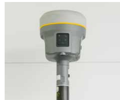
GNSS測量の受信機
